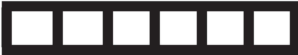
MALLI: PUUSTA VALMISTETTU APURUNKO SAHALLE. PUUN HALKAISIJA 150x150mm TAI VASTAAVA
